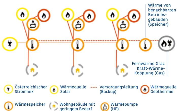
*Energieversorgungssystem der Plus-Energie Siedlung Reininghaus Süd. Die Wärmeversorgung erfolgt über lokale Quellen wie Geothermie und Solar, bei Bedarf wird die Temperatur über eine stromgespeiste Wärmepumpe angehoben.*
